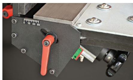
Einfache Einstellung der Fasenbreite
