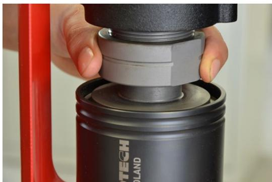
Das Gewindeschneidfutter mit Sicherungsmutter schützt das Gewindeschneidwerkzeug gegen Herausziehen
