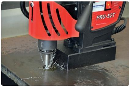
Durchgangsgewindebohren bis M20
