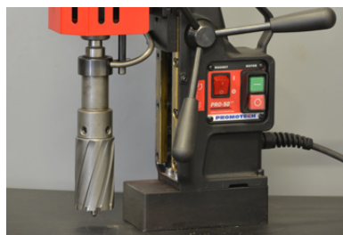
TCT-Fräser bis zu \Phi 45 mm mit Dorn AMT2-C19/2-3 für 75 mm Schnitttiefe
