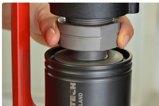
Gewindegewindeschneidfutter mit Sicherungsmutter
