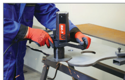
Gewölbte Kantenanfassen mit Radius
