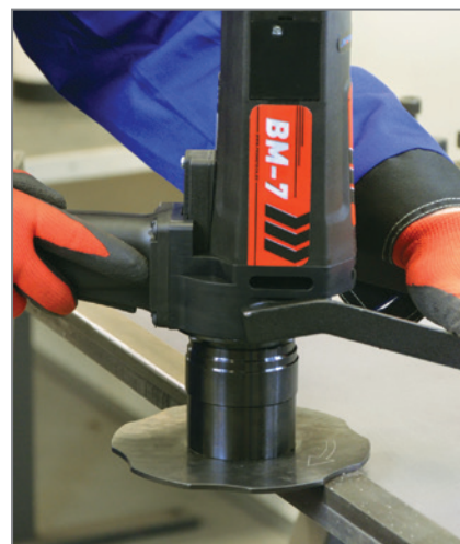
Gerade Kantenanfassen mit Radius
