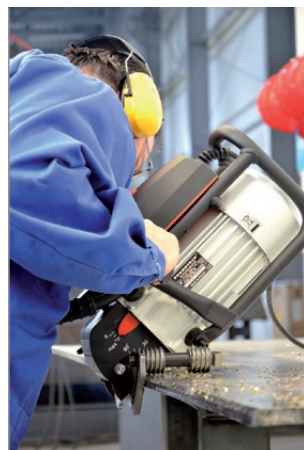
Fasen von Blechen
