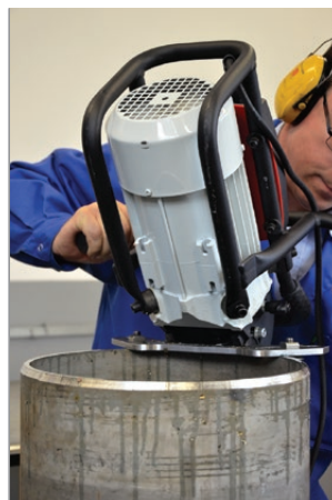
Fasen von Rohren
