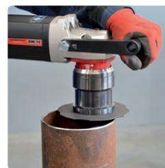
Anfasen von Rohren
