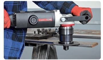
Anfasen von Stahlblechen
